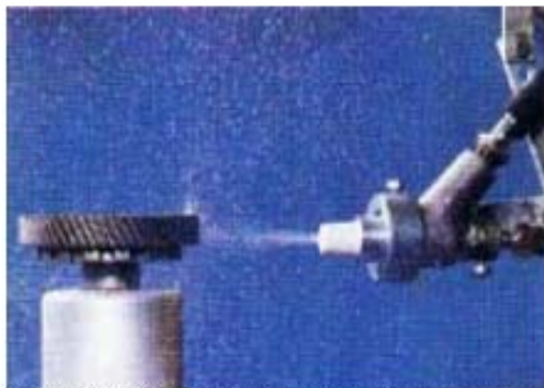
研磨材を高速で吹き付けるサンドブラスト加工 연마재를 고속으로 뿜어내는 분사가공
