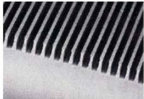
同装置で加工したPDP心臓部・リブ部分 분사장치로 가공한 PDP심장부 격벽부분
