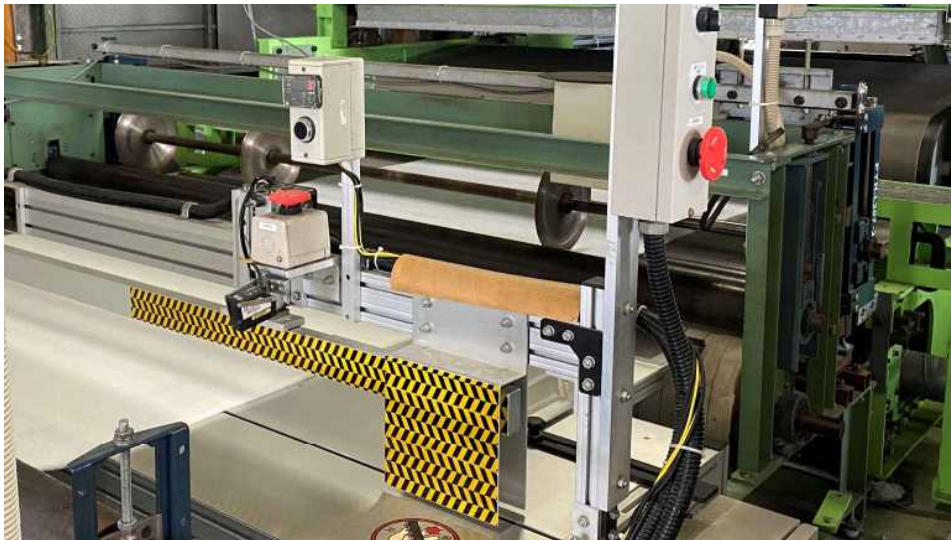
〈그림 2〉 이물질 검지기가 부착되어 있는 부직포 제조 라인
