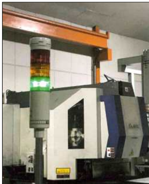
〈그림 2〉 복합기의 적층등에 설치된 감지 센서
