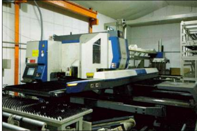
〈그림 1〉 금형방식과 레이저 가공방식의 작업이 가능한 복합기
