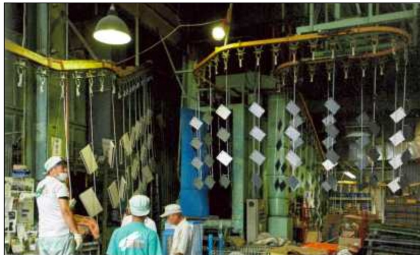
〈그림 4〉 도금 과정이 긴 컨베이어 라인, 한 곳이 멈추게 되면 전라인이 멈추게 됨
