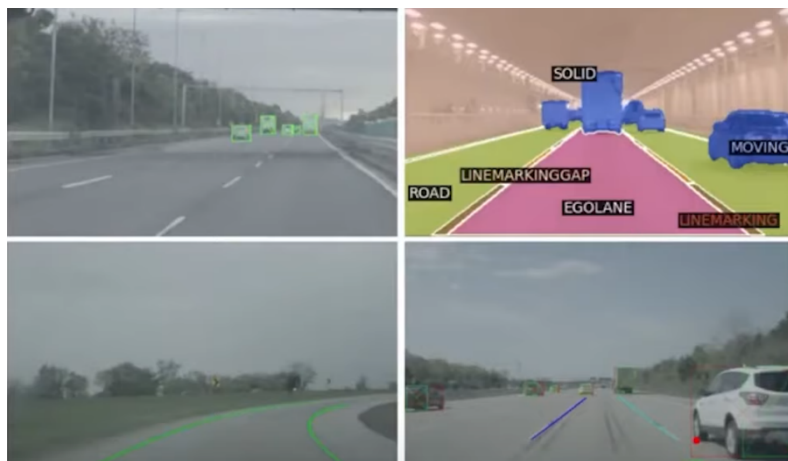
<도표 19> Semantic Segmentation에 의한 입체물 및 도로 인식
