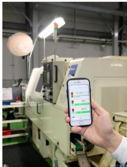
(사진) 교타나베 공장에 도입한 가동 모니터링 소프트웨어 '미타몬'. OS의 제약이 없어, 스마트폰이나 태블릿 단말에서 체크하기 용이한 모니터링 시스템을 구상 가능.
