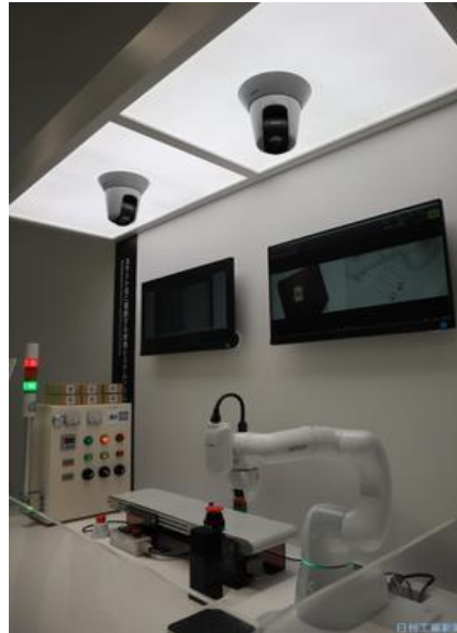
(사진) 천장에 설치한 네트워크 카메라로 계측기기의 인식이나 협동 로봇의 서포팅이 가능함.
