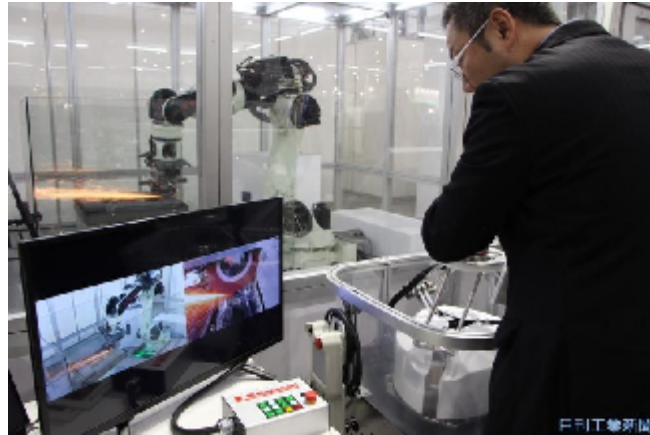
(사진) 가와사키 중공업이 2020년 4월 발매하는 연삭용 원격 조종 로봇 시스템 “석세서-G”
