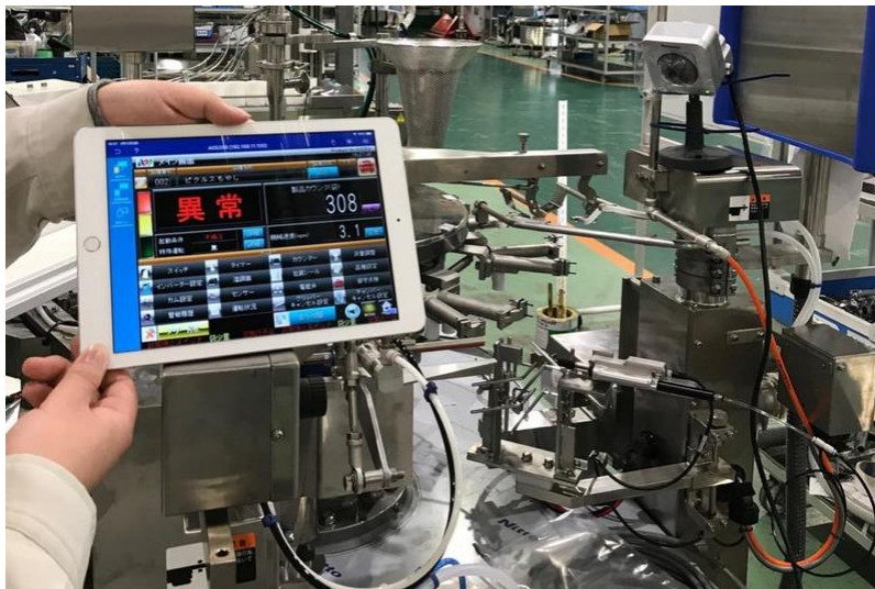
(사진) 식품 충전 포장기의 상태를 수집하고 태블릿에 알기 쉽게 표시
