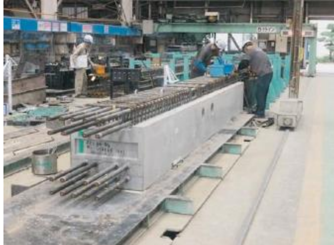
(사진) PC부재의 제조 라인. 작업자의 헬멧에 BLE 태그를 부착, 사람의 움직임 데이터를 수집함.
