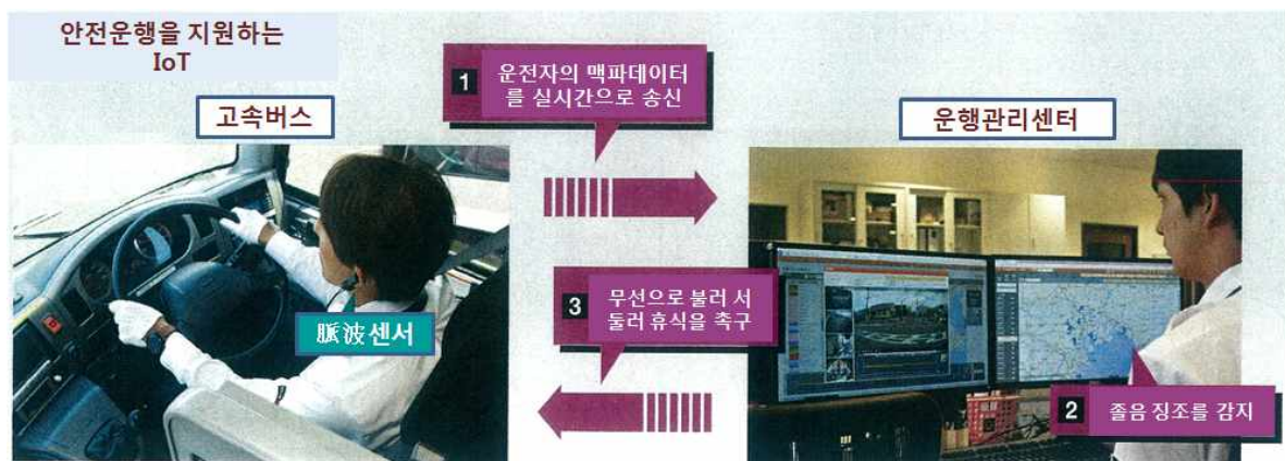
&lt;그림2&gt; 운전자의 졸음 감지 시스템
